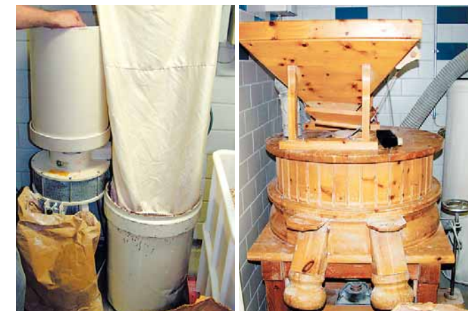
Ein Grossteil des Mehls wird in einer Zentrofan- (links) oder einer Steinmühle (rechts) selbst gemahlen.
