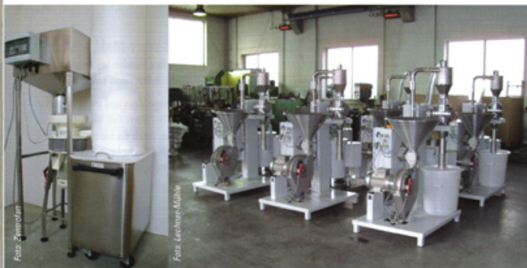
Links: Zentrifugalmühlen haben einen stillstehenden, zylindrischen Mahlstein aus Basalt-Lava. Rechts: Der Mühlomat von Lechner mahlt hygienisch und fast staubfrei.
